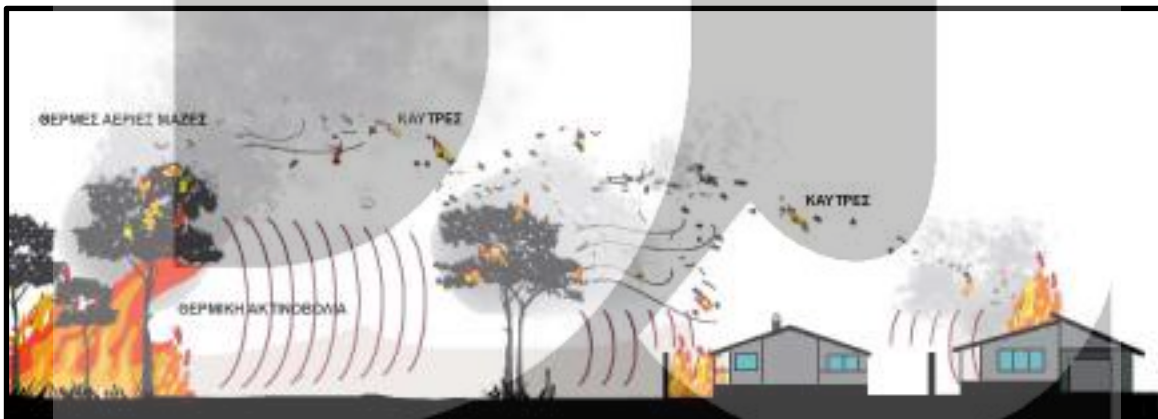
Σχέδιο 1. Τρόποι ροής της θερμότητας σε μια δασική πυρκαγιά, που εξελίσσεται πλησίον κτιρίων και απεικόνιση τρόπου μετάδοσης δασικής πυρκαγιάς με μεταφερόμενες καύτρες σε κτίρια (R. Blanch /CSIRO, 2021)
